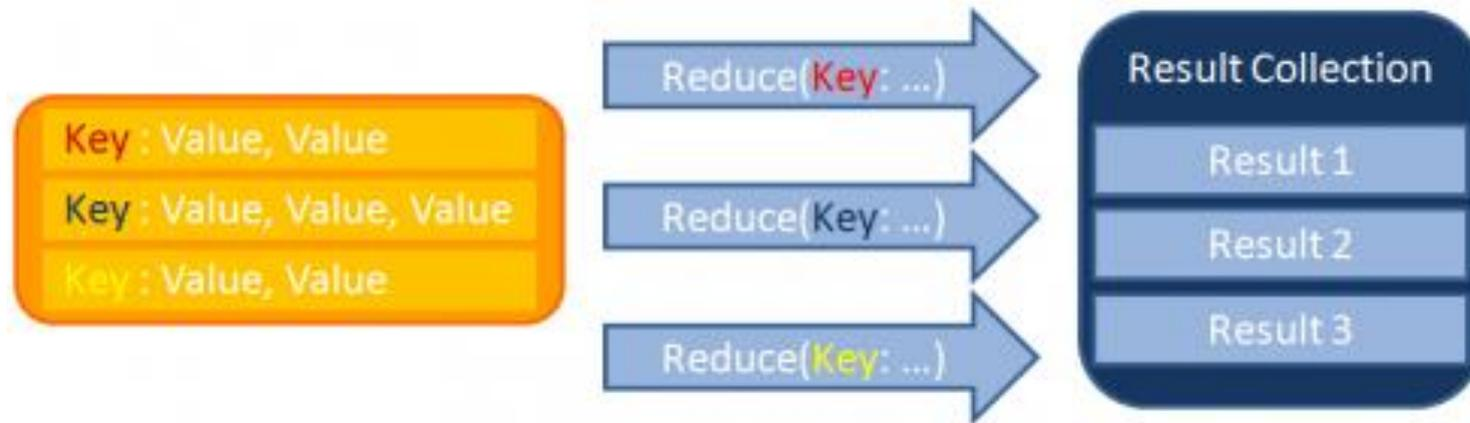
На Reduce-шаге происходит свёртка предварительно обработанных данных — для этого необходимо, чтобы все результаты предварительной обработки с одним конкретным значением ключа обрабатывались одним рабочим узлом кластера в один момент времени.
